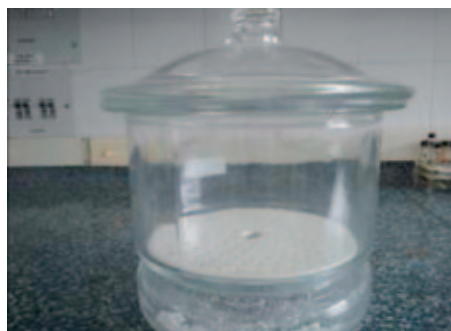
FIGURA 3. Desecador con anhídrido de sulfato
