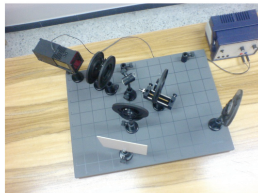
FIGURA 4. ESQUEMA Y MONTAJE EXPERIMENTAL DEL REFRACTÓMETRO (MEDICIÓN DE GROSOR APARENTE DELLENTE).
