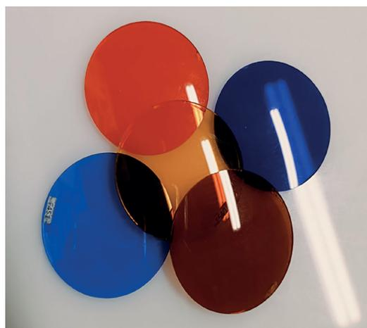
FIGURA 3. Modelo de los diferentes tipos de filtros de absorción
